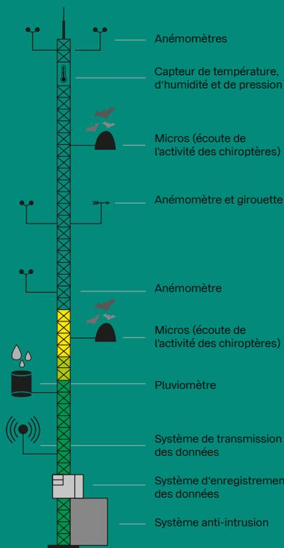
Schéma d'un mât de mesure de vent
